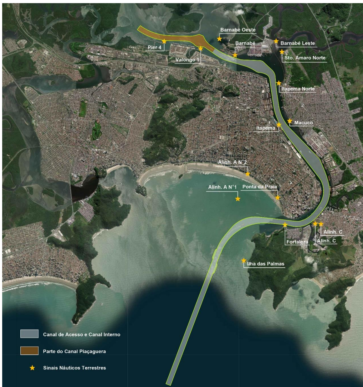
Figura 6 - Indicação dos sinais náuticos terrestres sobre aerofoto
